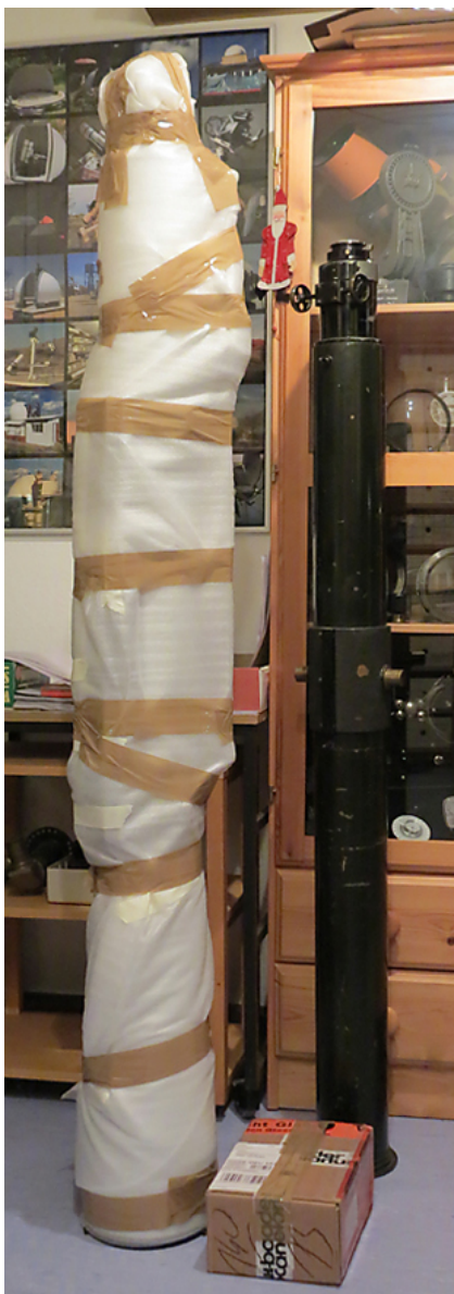
Das fertige Teleskop mit Okularauszug, Sucher und Laufgewicht, montiert in Rohrschellen und 3" Baader Schwalbenschwanzschiene
