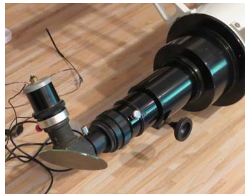
Der fertige Tubus mit eingesetztem Objektiv, Okularauszug und der Messingplatte
