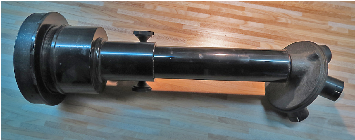
Der Okularauszug mit Tubusflansch und 4-fach Okularrevolver
