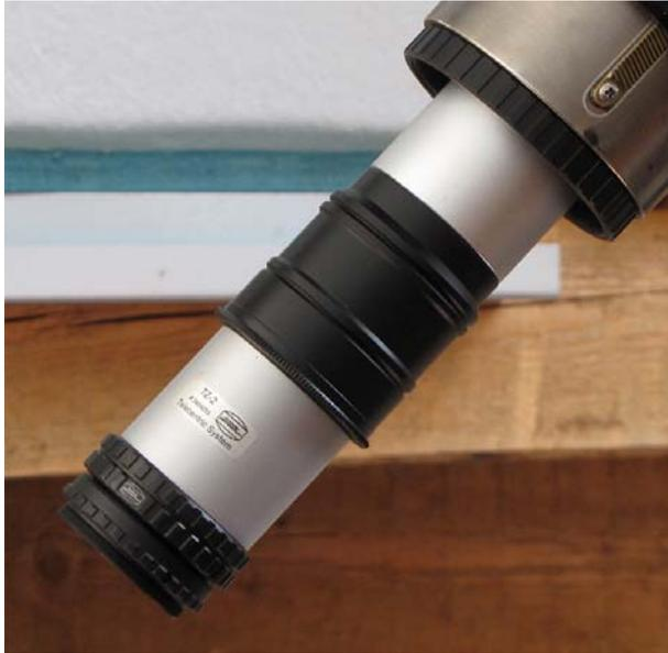
Das Bild links zeigt den Telezentrischen Ansatz am Okularauszug des Sonnentele-skops. Die Optik des Systems sitzt in der schwarzen Hülse etwa in der Mitte. Das System endet mit einem T2 Gewinde an welches – über ein Übergangsgewinden – das SolarSpectrum Filter montiert.
