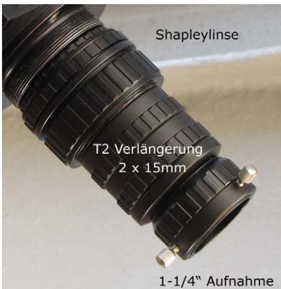
Das Bild links zeigt als Beispiel zwei T2 – 15mm Baader Verlängerungshülsen zwischen Reducer und fokussierbarer 1¼" Aufnahme, welches in etwa den Reduktionsfaktor von 0.6-fach entspricht.
