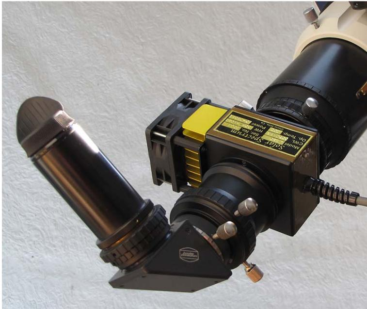
**SolarSpectrum Filter** sind mit den Halbwertsbreiten 0,8, 0,7, 0,65, 0,5 und 0,3 Å lieferbar. Um die schmalen Halbwertsbreiten realisieren zu können, müssen diese Filter beheizt werden und erfordern einen annähernd parallelen Strahlengang des Teleskops von f/30. Die Preise sind abhängig von der Halbwertsbreite und vom freien Durchmesser der Filter.
