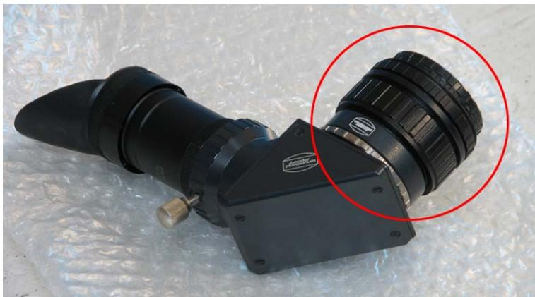
Das Bild links zeigt als Beispiel den 0.7x SolarSpectrum Reducer (roter Kreis) vor einem 1¼" Zenitprisma für die visuelle Beobachtung.
